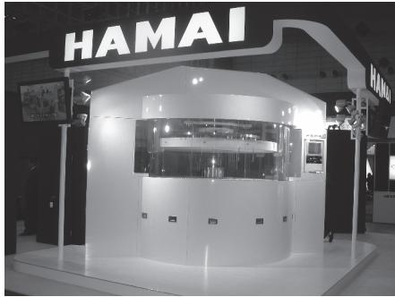
Φ300mm×20枚/バッチのクリーンルーム対応機 32BF-DSP
