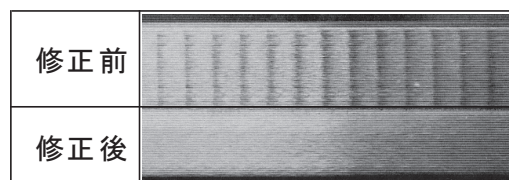
図1 金属除去による振れ修正の確認
