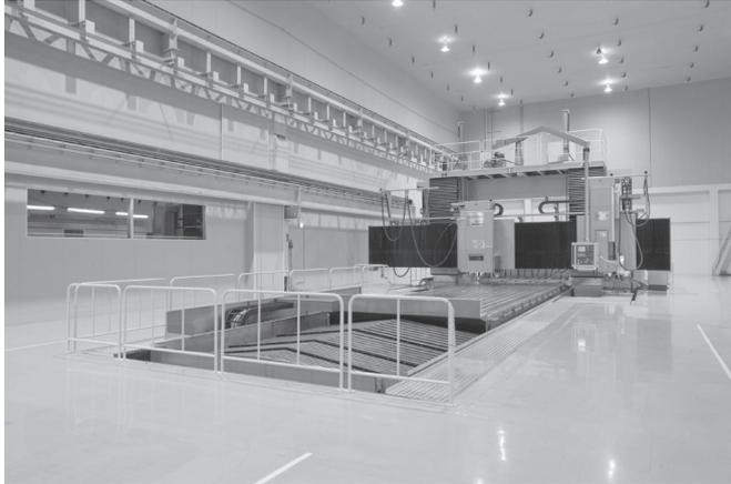
記事の中でもご紹介のあった、超精密高剛性門型研削盤「UDG10035NC」。実際に見せていただきましたが、ほんとに大きい! この大きさを0.5 $\mu$ mの真直度精度というのですから驚きですよ。平面研削盤で最も重要とされる「案内面」に着目し、従来の油静圧案内面とはまったく違う構造で取り組んだ『非接触式可変静圧スライドシステム』を搭載した、画期的な超精密平面研削盤なのです☆
