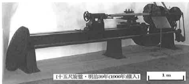
図2 旧熊本高等工業学校創設時に購入の大型実用旋盤
