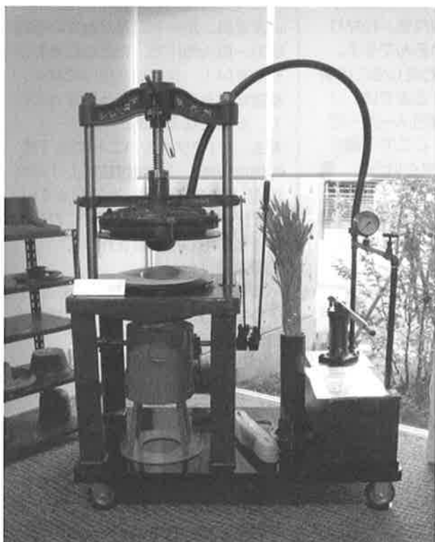
図3 麦藁帽子製作用水圧機
