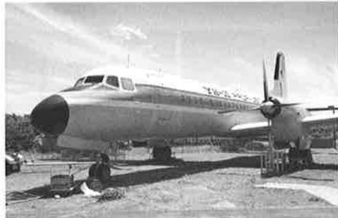
YS-11は、ガスタービンエンジン2台、60人乗りのプロペラ機で、第二次世界大戦後現在までのところ、日本で設計・製造された唯一の旅客機である。同機は、1962年に初めて飛行し、慎重な試験飛行の後、運航が開始され、機体の欠陥によるさしたる事故もなくその設計の優秀さを示しているが、残念ながら40年近い活躍を終え、2006年9月末をもって日本国内のエアラインからは引退した。「YS-11」の製造は、日本の産業全体からみても、歴史に残るマイルストーンと考えられるが、その試作1号機が、開館以来当館の屋外展示場(現在MU-2など18機展示)を飾っており、退役後の勇姿を見ることができる。
