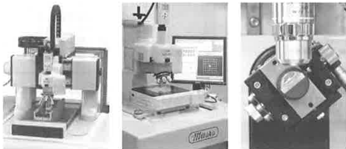
←三鷹光器が誇る3次元測定器。 左から、数々の受賞歴をもつ NHシリーズ、MLA専用特性 評価装置NH-3MA、高NA 非球面形状測定装置NH-3SE
