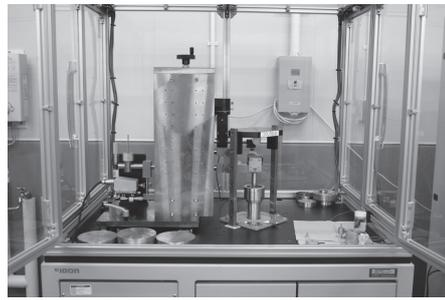
ネオスさんの広域荷重摩擦摩耗試験機。その名の通り、非常に広い範囲で荷重(100g~100kg)を変化させたり、液の温度も変化させながら、摩擦係数を測定する試験機です。切削液や研削液を開発する際の基礎検討で活躍している試験機なのだそう☆
