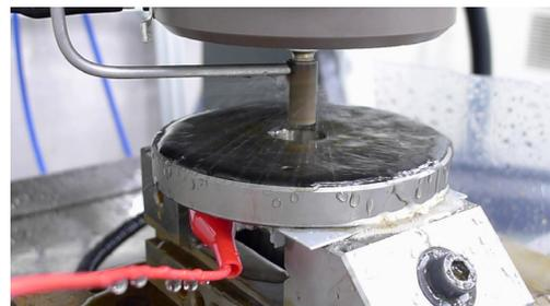
図7 チタンボンドCBN砥石による鉄内周面のヘリカル研削加工
