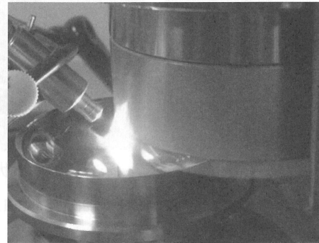
図1 UVアシスト定圧研削の様子
