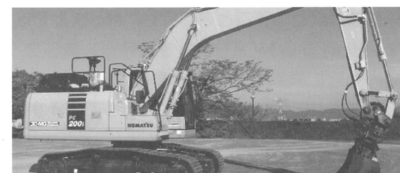
図4 ショベルカーの刃先の自動制御のための機体計測
