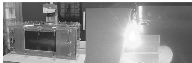
図2 現象評価用粉末床溶融結合装置
