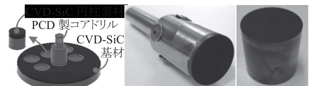
くり抜き加工法 PCD 製コアドリル CVD-SiC 円柱 多結晶ダイヤモンド(PCD)製コアドリルの開発
