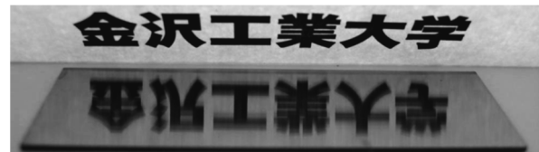
図 3 樹脂コーティングワイヤによるシリコンの切断面
