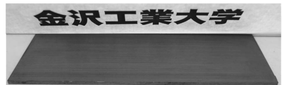
図 2 従来の遊離砥粒方式で切断したシリコンの切断面
